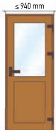
Maximale Bautiefe der Tür aus Farbprofil - 940 mm (bei einer Höhe von nicht mehr als 2040 mm);
