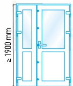
Minimale Bauhöhe der Stulptür mit Mehrfachverriegelung (in fünf Punkten) - 1900 mm.
