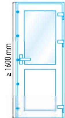
Minimale Bauhöhe der Tür mit Mehrfachverriegelung (in fünf Punkten) - 1600 mm
