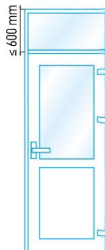
Zulässig die Anfertigung als einheitliche Konstruktion mit Scheinverglasung oder Oberflügel (Oberflügelhöhe bis auf 600 mm) der Eingangstür mit Innenaufschlagklappe und Balkontür mit Schwelle
