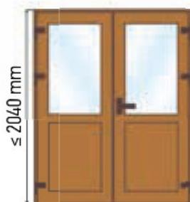
Maximale Bauhöhe der Tür aus Farbprofil - 2040 mm;
