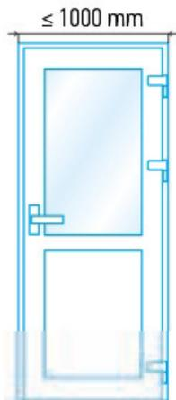
Maximale Bautiefe der Tür aus weißem Profil - 1000 mm (bei einer Höhe von nicht mehr als 2140 mm);
