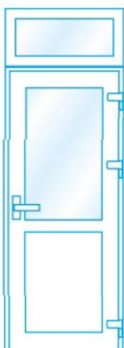
Eingangstür mit dem Flügel (T-Flügel), für den eine Außenöffnung vorgesehen ist, mit der Festverglasung oder mit dem Oberflügel oben wird in einzelnen Konstruktionen mittels des Verbinders gefertigt.
