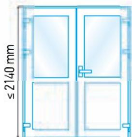
Maximale Bauhöhe der Tür aus weißem Profil - 2140 mm;
